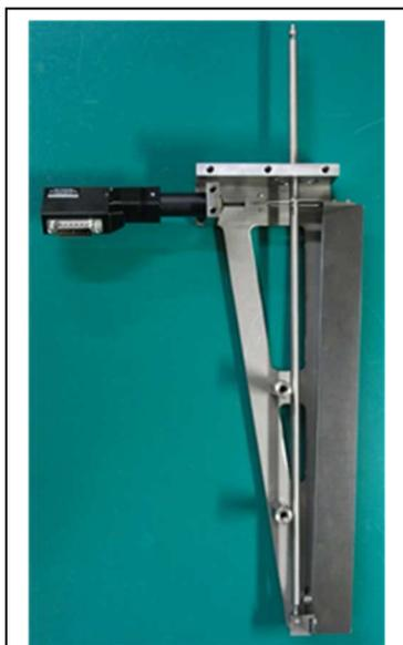
図 2.12：アクチュエータと減速機の構造
