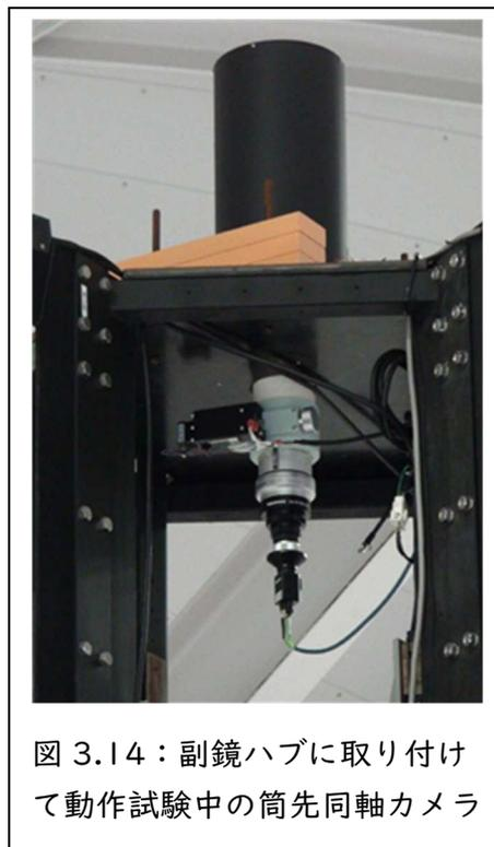
図 3.14：副鏡ハブに取り付けて動作試験中の筒先同軸カメラ
