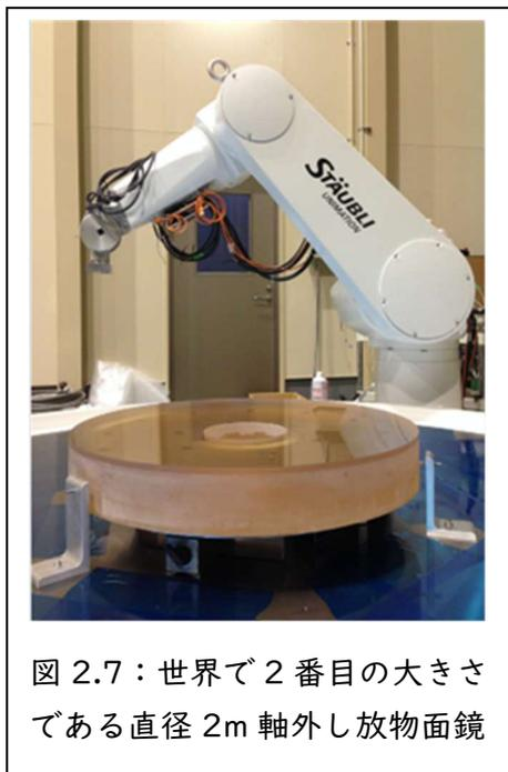
図 2.7：世界で2番目の大きさである直径2m軸外し放物面鏡
