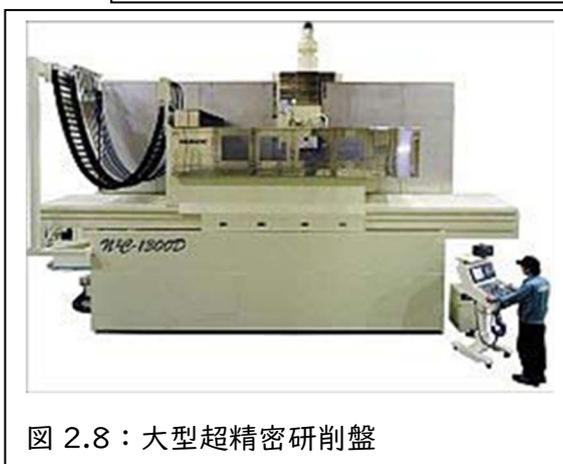
図 2.8：大型超精密研削盤
